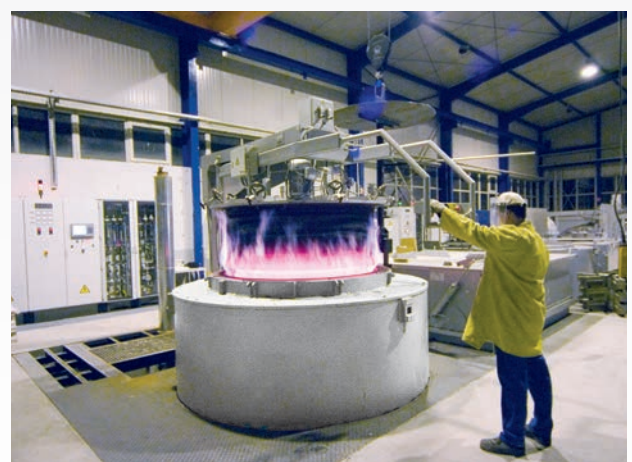
Kammerofen bis d=1250mm
