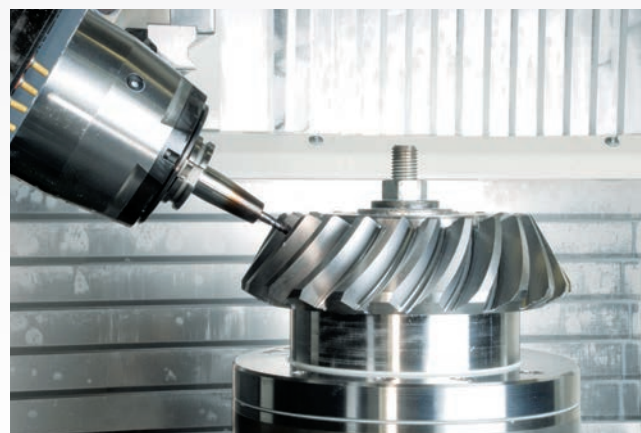
5-Achs-CNC-Fräsen - Max. Ø: 2800 mm
