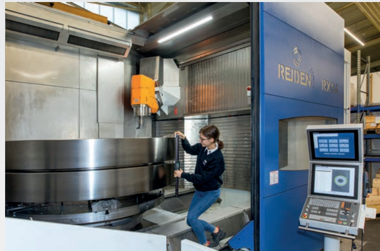
5-Achs-Dreh-Fräszentrum zur Weich- und Hartbearbeitung
